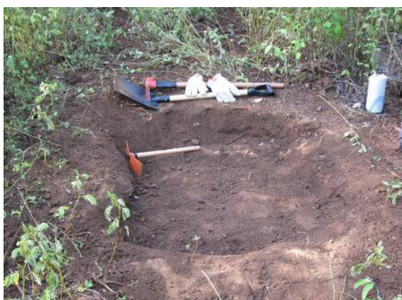
Figura 11.1-76: Escavação no horizonte chernozêmico para coleta de amostras para análise química.
