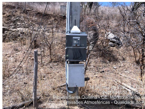
FFigura 11.1-30: Posicionamento do equipamento de medição no P2 (1ª campanha).
