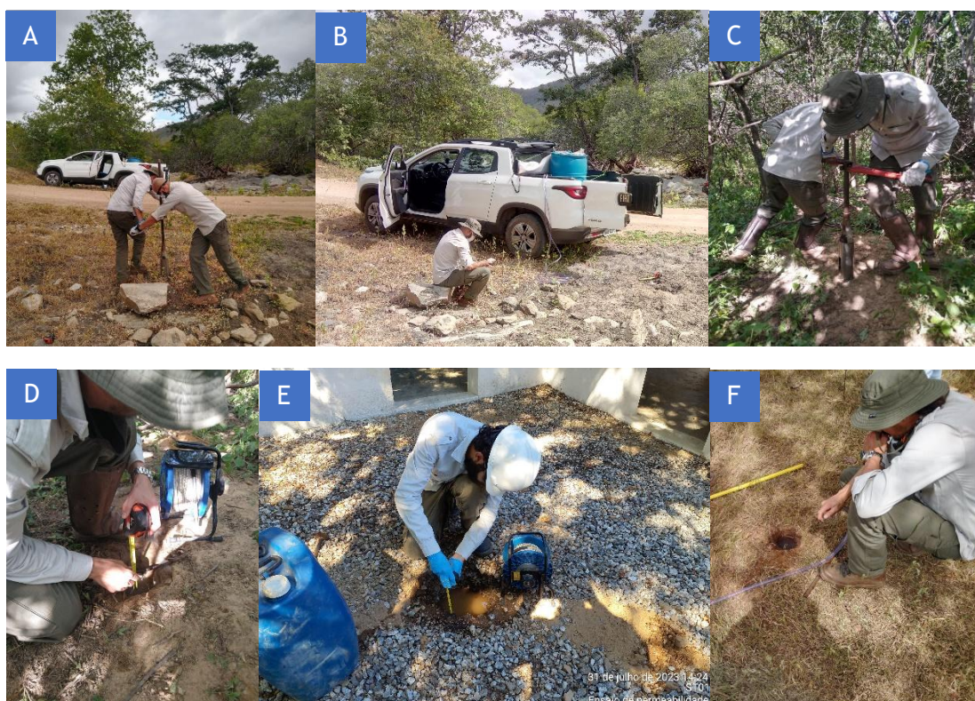
Figura 11.1-75: A) e B) Perfuração da Sondagem e Ensaio de Rebaixamento 1- Neossolo Flúvico. C) e D) Perfuração da Sondagem Ensaio de Rebaixamento 3- Neossolo Litólico. E) Ensaio de Rebaixamento 4- Cambissolos. F) Ensaio de Rebaixamento 2 - Chernossolo Rêndzico.
